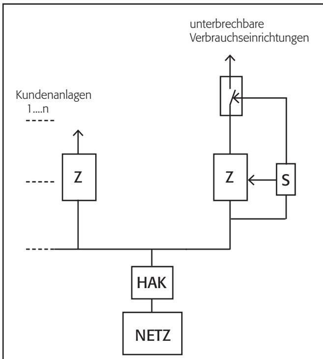
**Bild1: Anschluss Wärmepumpenanlage**
