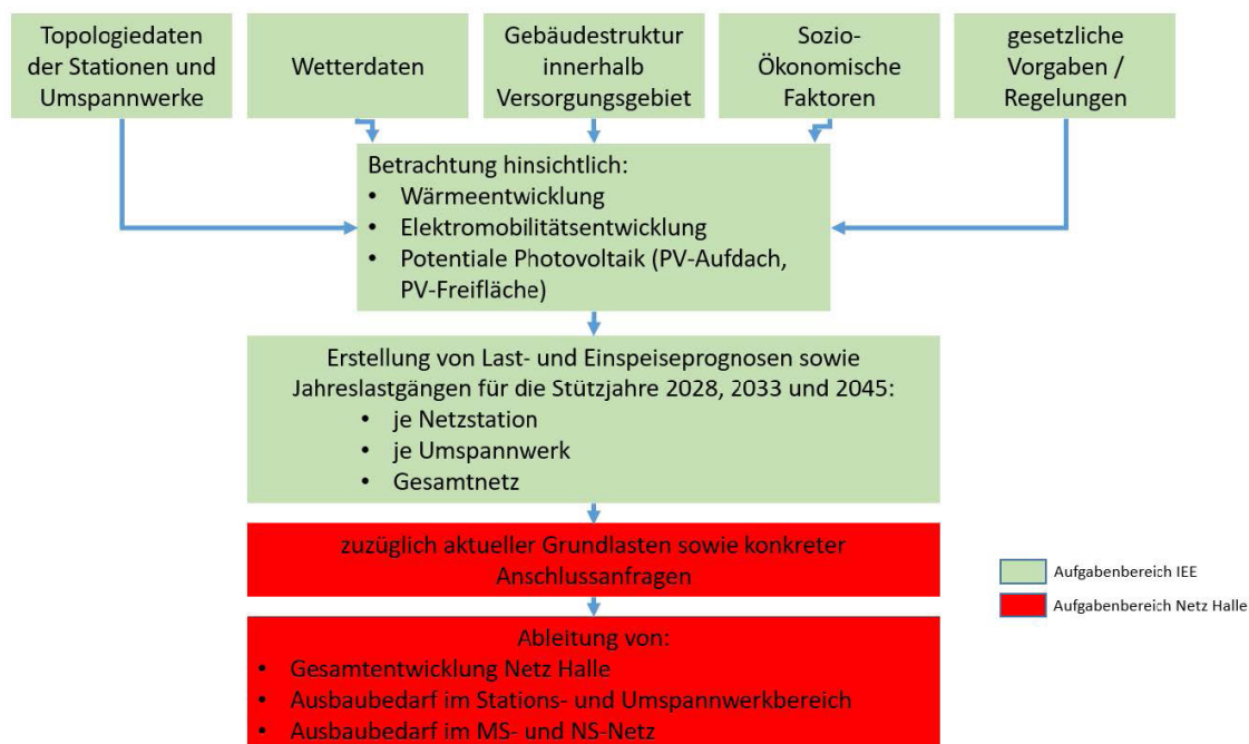
Abbildung 3: Darstellung des Modells zur Einspeise- und Lastprognose
